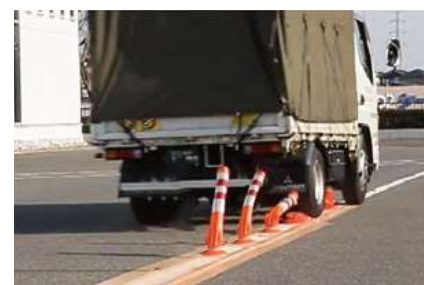
2tトラック 60km/hで繰り返し試験
